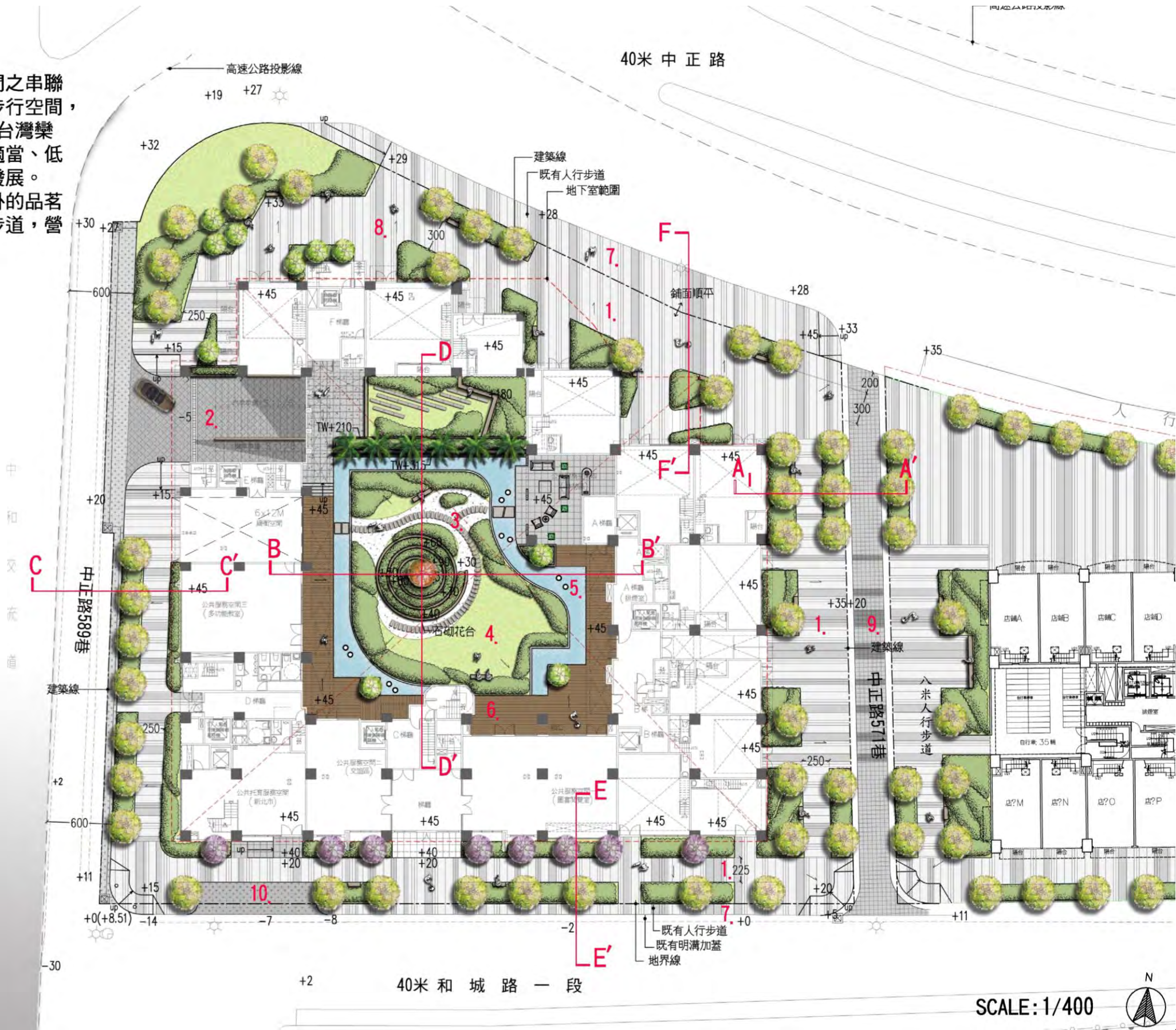
圖12-4 一層景觀配置平面圖(S=1/400)
